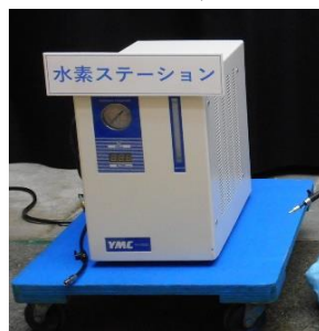
「水素発生装置」
